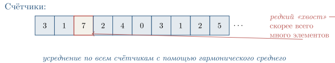
Рисунок 2. Рис. 4.18. Множество счётчиков HyperLogLog. Каждый запоминает максимальную длину «хвоста нулей» для своего подпотока.
