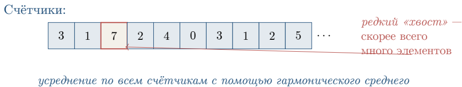
Рис. 5.18. Множество счётчиков HyperLogLog. Каждый запоминает максимальную длину «хвоста нулей» для своего подпотока.
