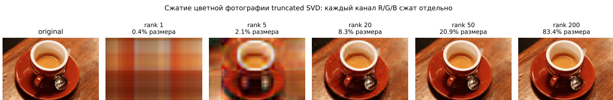
Рис. 3.4. Цветную фотографию сжимаем поканально: SVD ранга r для каждого из R, G, B и склейка. Под каждым кадром — доля памяти от оригинала. Варианты для цвета: t.me/fminxyz/16 .
