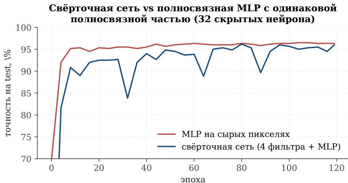
Рис. 4.20. Сравнение точности на тесте для полносвязной MLP и простой CNN с теми же финальными скрытыми слоями. На крошечных изображениях 8 \times 8 из UCI Digits разница невелика — задача слишком проста, локальная структура почти не помогает. На полномасштабном MNIST 28 \times 28 CNN превосходит MLP на 1–2 процентных пункта; на цветных изображениях ImageNet ( 224 \times 224 ) — уже на 10–15 процентных пунктов.
