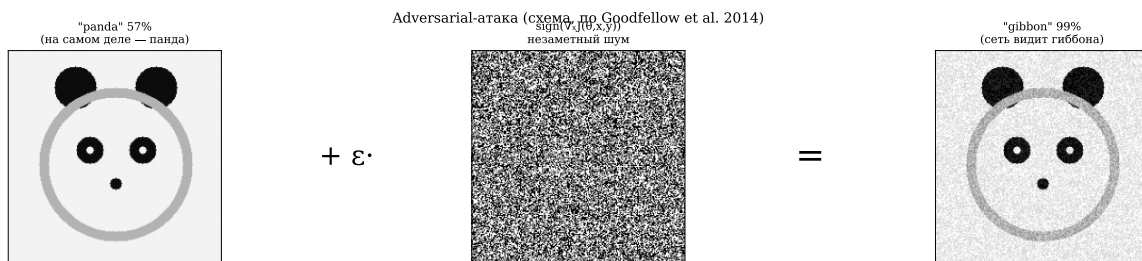
Рис. 3.12. Adversarial-атака на нейросеть (Goodfellow et al., 2014). Слева — оригинал, классифицирован как «panda» с уверенностью 57,7%. В центре — почти невидимое возмущение, масштабированное для наглядности. Справа — атакованный пример, классифицируется как «gibbon» с уверенностью 99,3%.
